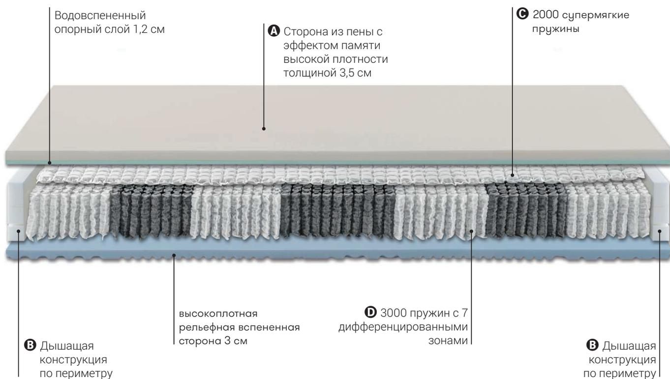
**A** 3,5-сантиметровая сторона из термочувствительной пены с эффектом памяти, само моделирующей для равномерного распределения веса тела
